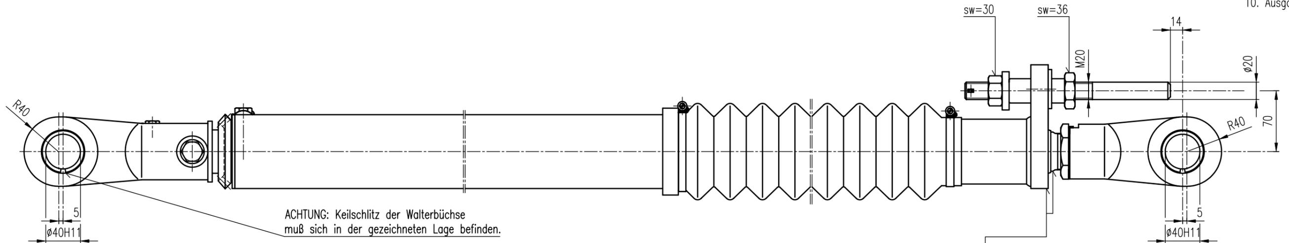
Achtung: Beim Festziehen des Vorderen Kopfstückes müssen beide Markierungen in einer Linie sein. Auch bei der Montage auf der Lokomotive beachten!
