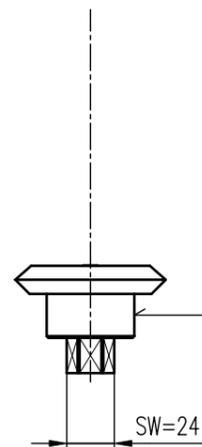
Kegelrad zur Rückstellung des Bremsgestängestellers
